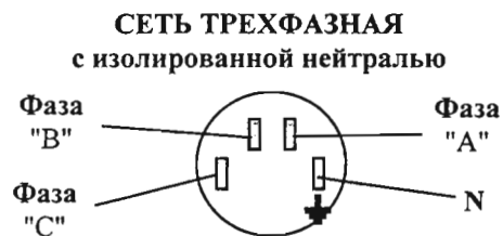
Рисунок 1 Схема подключения цепей питания стабилизатора R 6000-3 (Вид на розетку с внешней стороны)
