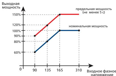
**Рисунок 9.** Зависимость выходной мощности от входного напряжения
