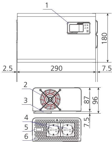
**Рисунок 2б.** Габаритные размеры, компоненты передней и боковой панели стабилизаторов Штиль IS1000, IS1500 и IS2000
