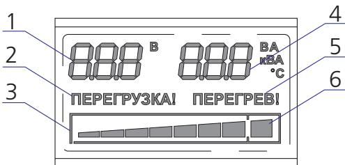
**Рисунок 6.** ЖК-дисплей стабилизаторов Штиль IS1000, IS1500, IS2000, IS2500, IS3000 и IS3500
