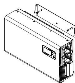
**Рисунок 10в.** Крепление стабилизаторов Штиль IS2500, IS3000 и IS3500 на ровной вертикальной поверхности
