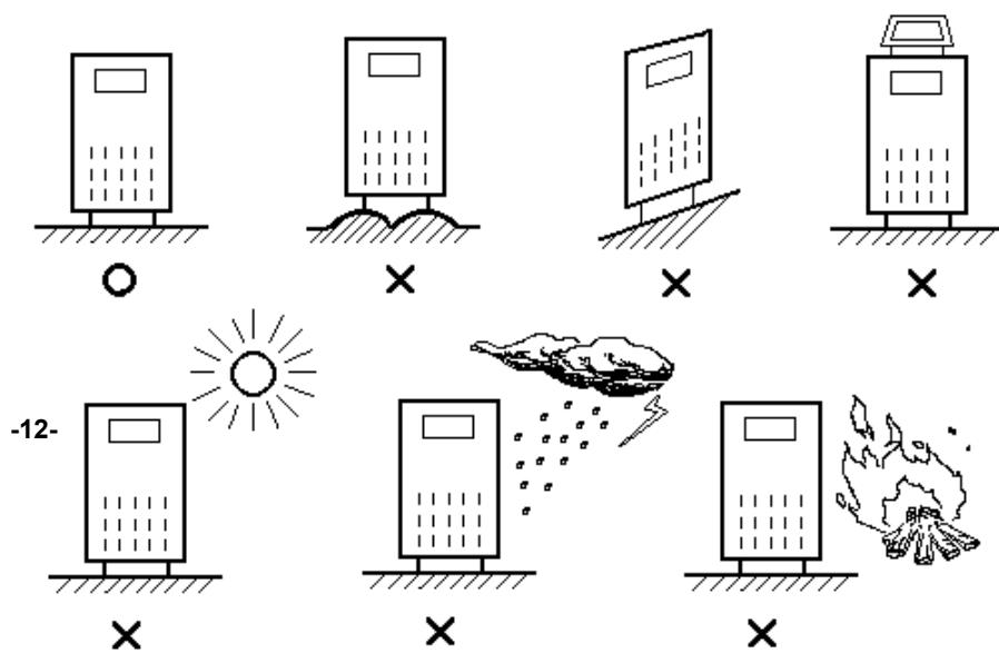
Рис. 3-1 Предупреждения при установке ИБП
