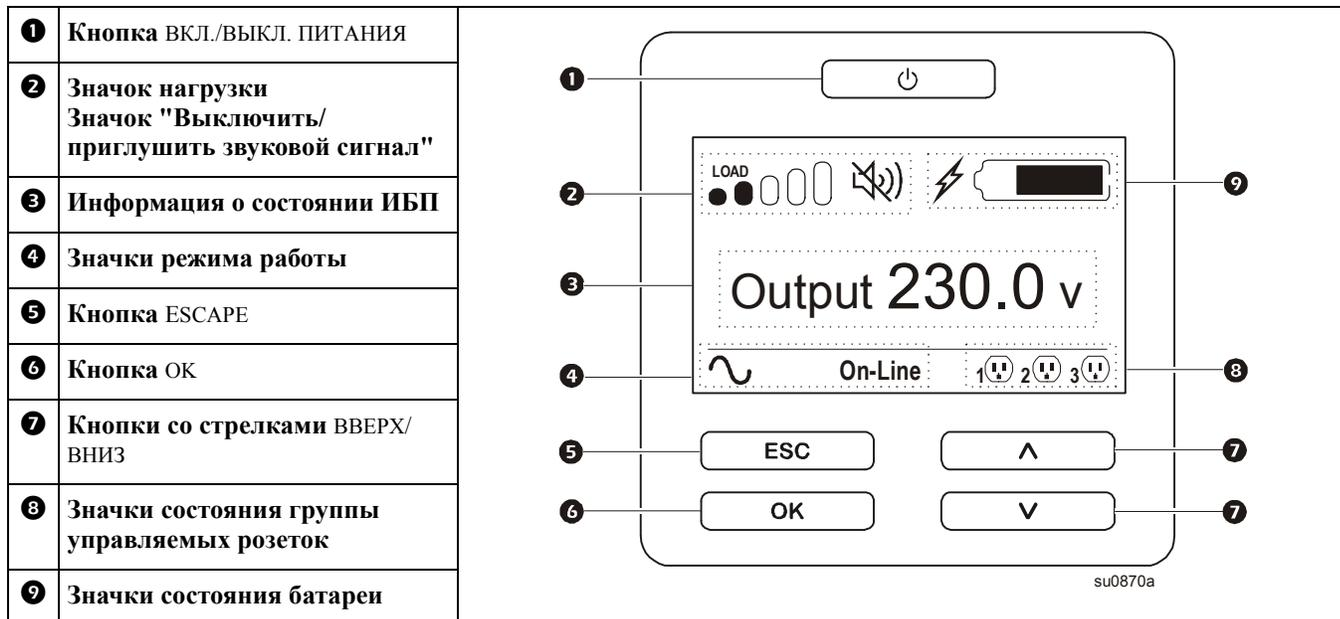
В течение двух минут с момента установки батареи на дисплее отображается дата установки батареи. Если на дисплее не отображается дата установки, с помощью кнопок со стрелками ВВЕРХ/ВНИЗ перейдите в меню "Настройка" > Батарея и введите правильную Дату установки.
