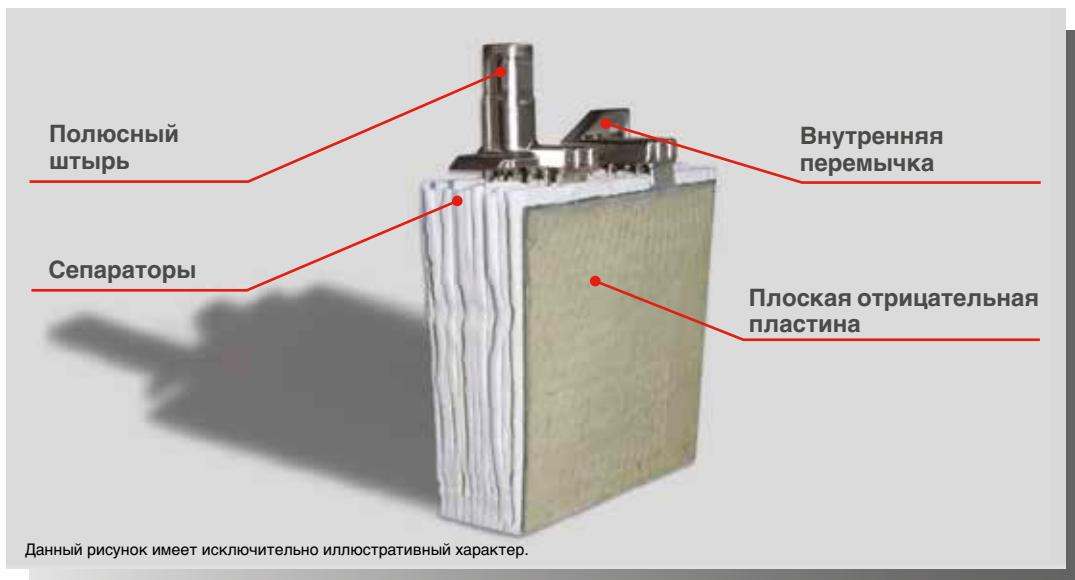
В СЕРИИ АККУМУЛЯТОРОВ FIT ПРИМЕНЯЕТСЯ ТЕХНОЛОГИЯ AGM (ABSORBED GLASS MAT – ПОРISTЫЙ ЗАПОЛНИТЕЛЬ ИЗ СТЕКЛОВОЛОКНА). ЭЛЕКТРОЛИТ ПОЛНОСТЬЮ ВПИТЫВАЕТСЯ СЕПАРАТОРОМ ИЗ СТЕКЛОВОЛОКНА, ЭФФЕКТИВНОСТЬ РЕКОМБИНАЦИИ ГАЗОВ СОСТАВЛЯЕТ 99 %. МОНОБЛОКИ ХАРАКТЕРИЗУЮТСЯ ПРОЧНОСТЬЮ, ГЕРМЕТИЧНОСТЬЮ И НЕ ТРЕБУЮТ ДОЛИВКИ ЭЛЕКТРОЛИТА В ТЕЧЕНИЕ ВСЕГО СРОКА СЛУЖБЫ АККУМУЛЯТОРА. ПОНИЖЕННЫЙ УРОВЕНЬ САМОРАЗРЯДА ОБЕСПЕЧИВАЕТ ПРОДОЛЖИТЕЛЬНОСТЬ РАБОТЫ БЕЗ ЗАРЯДКИ ВПЛОТЬ ДО 6 МЕСЯЦЕВ.
