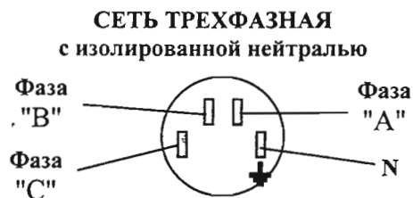
Рисунок 1 Схема подключения цепей питания стабилизатора R 3600-3 (Вид на розетку с внешней стороны)
