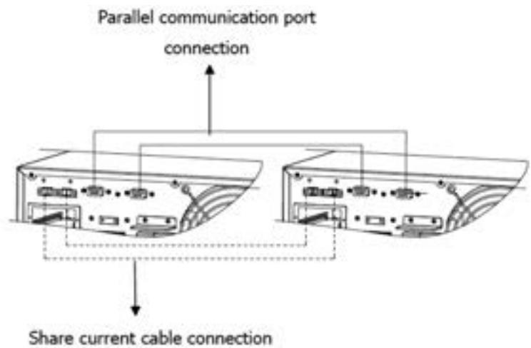
Рис. 13: Схемы соединений для моделей ИБП в корпусах типа Rack
