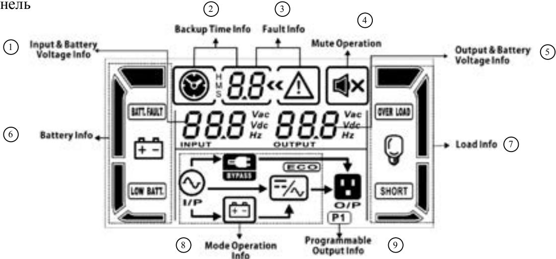
1. Информация о параметрах входа и напряжении батареи (**Input & Battery Voltage Info**)
