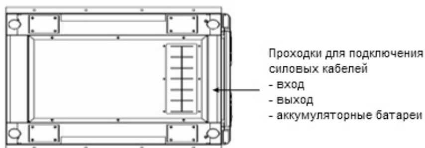
Рисунок 2.6 Проходки для ввода кабелей ИБП 80 кВА – 120 кВА
