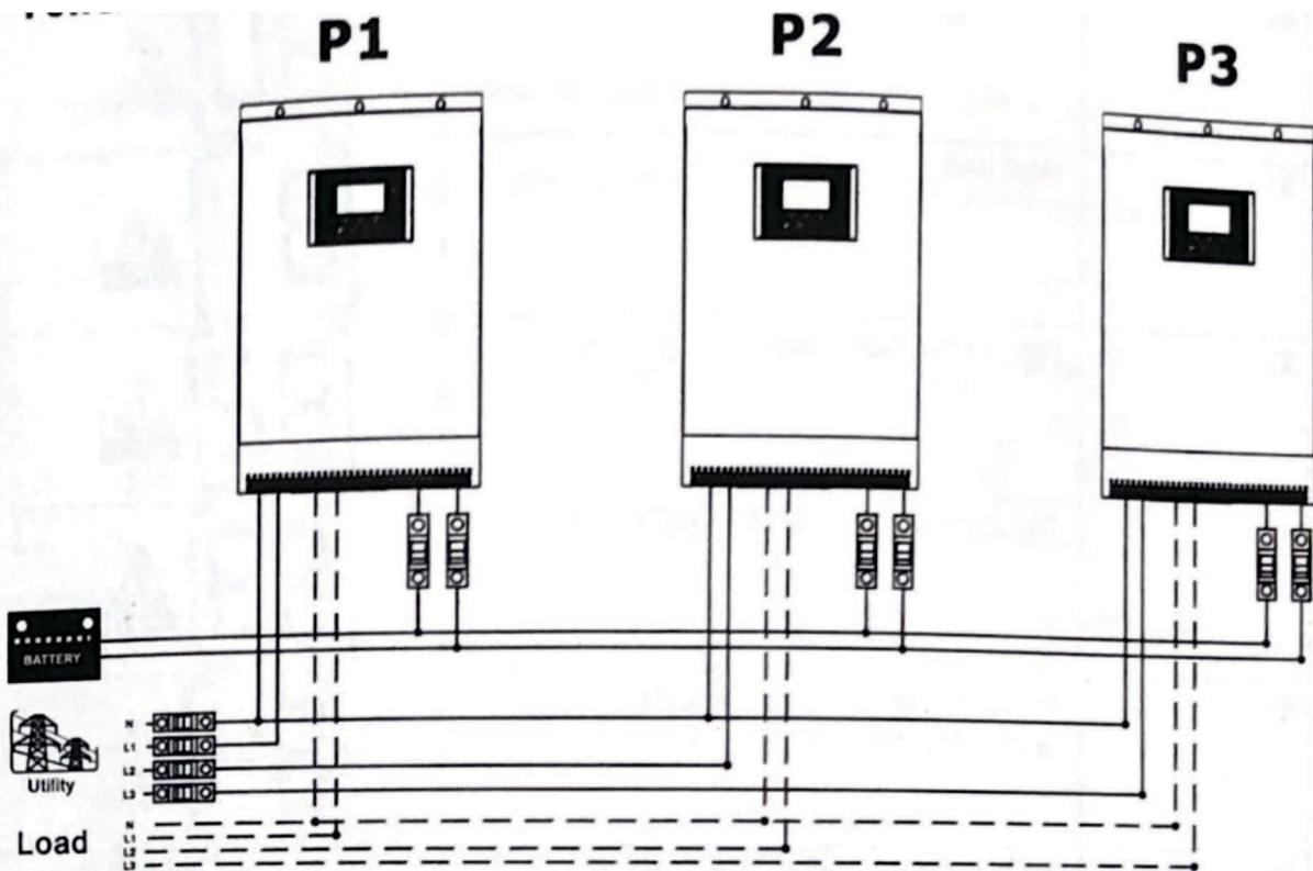
\* - Входную и выходную нейтрали допускается объединять.
