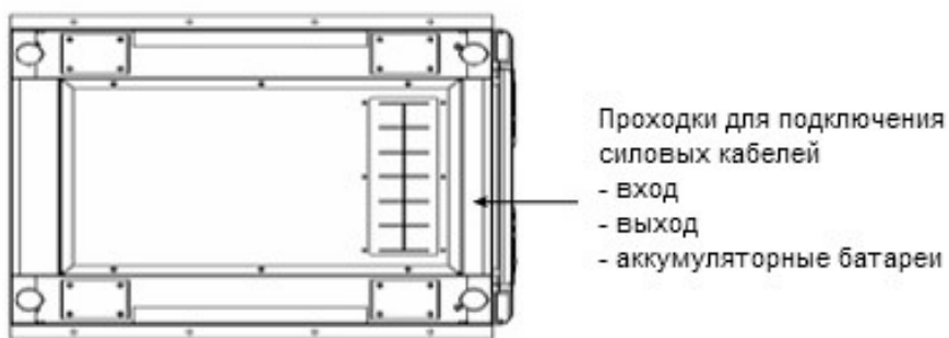
Рисунок 2.6. Проходки для ввода кабелей ИБП 80 кВА – 120 кВА
