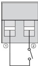
В нормальном режиме работы контакт 1 и контакт 2 порта замкнуты. В случае возникновения чрезвычайных ситуаций, когда необходимо быстро отключить по энергоснабжению нагрузку, нужно разорвать связь между контактами 1 и 2, вынув ответную часть из разъема порта EPO.
