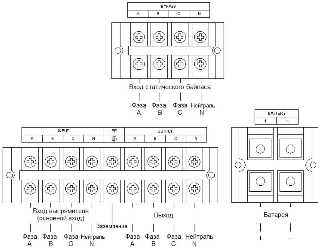
Расположение контактных выводов для ИБП 15 кВА - 30 кВА
