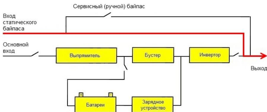
Схема работы в режиме неисправности.
