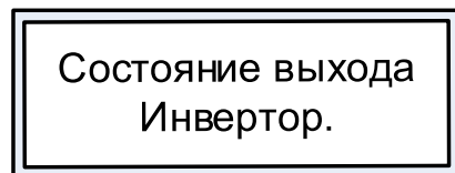
Рисунок 8. Отображение состояния выхода в режиме основного экрана
