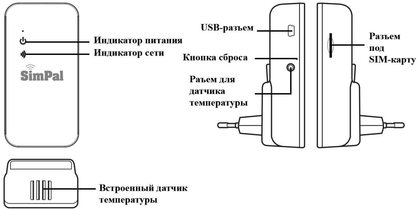
Рисунок 1. Элементы устройства
